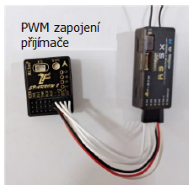
PPM, SBUS, IBUS, CRSF (Na obrázku je CRSF+TELE)
