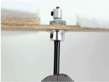
Nahoře: Upgradované ložisko náboje rotoru, namontované po prvním zkušebním letu.
