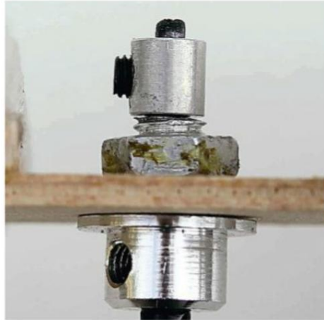
Ložisko pohonu vrtule při pohledu zespodu.
